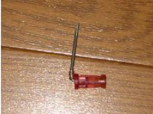
セーフティ針の一般的な針の曲がり方。針には粘りもあって、折れにくく混入しにくい
