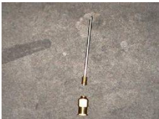
他社のストッパー針。針に変形はなくても、簡単に折れるので現場では使えない
